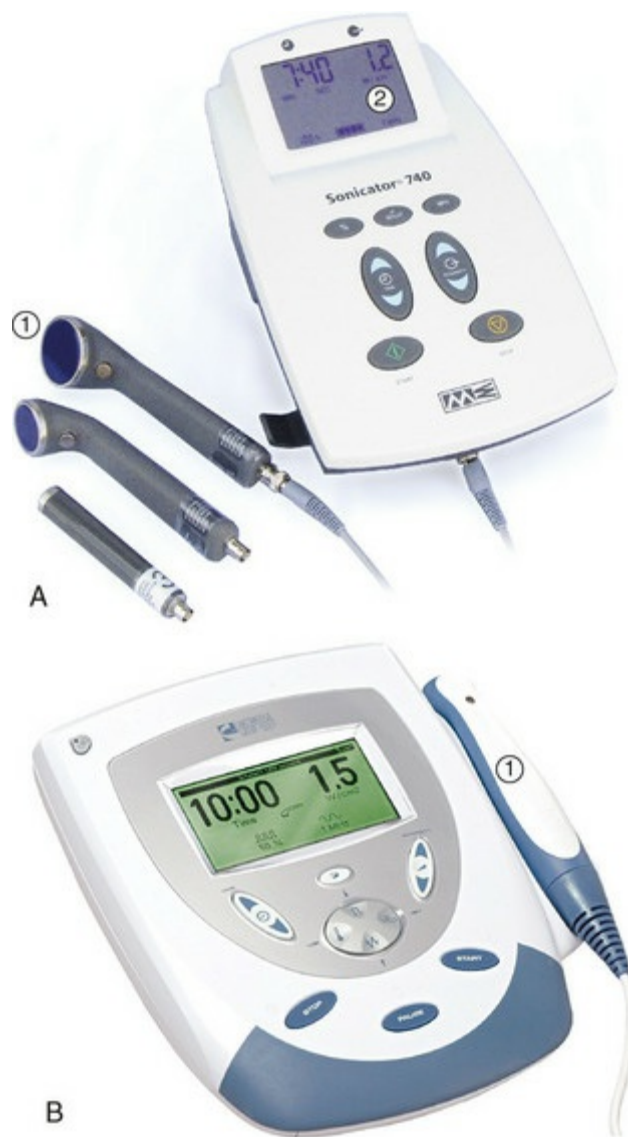
FIG 9-21 Unidades de ultrasonido: 1, transductor; 2, indicador de potencia/intensidad. A , Cortesía de Mettler Electronics, Anaheim, CA; B , cortesía de Chattanooga, Vista, CA.
