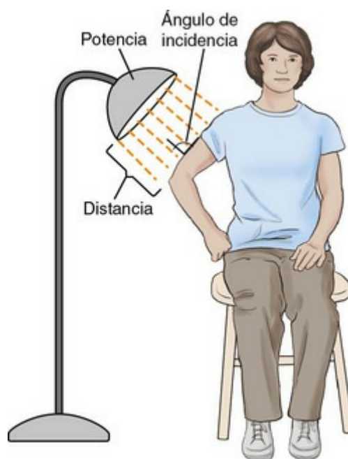
FIG 16-2 Factores que afectan a la intensidad de la radiación ultravioleta que llega a la piel del paciente: inversa del cuadrado de la distancia entre la lámpara y el paciente, potencia de emisión de la lámpara y coseno del ángulo de incidencia del haz con el tejido.
