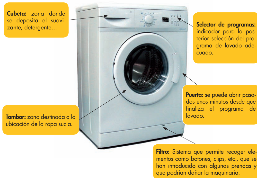
Fig. 4.7. Descripción de los componentes de una lavadora.
