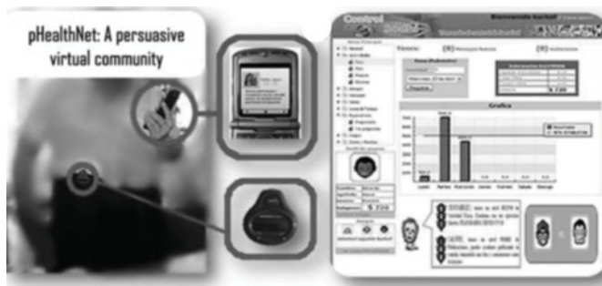
Figura 18-3. Sistema pHealthNet. A. El usuario recibe un mensaje persuasivo en su teléfono celular y utiliza un podómetro para estimar el número de pasos que ha caminado en el día. B. Sitio web con acceso a la información del participante y la red social.
