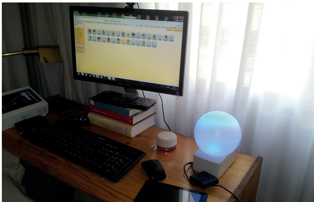
Figura 7.6. Prototipo utilizado en el Proyecto AGNES instalado en la casa de uno de los participantes. La esfera cambia de color cuando alguien de la red social ModernFamilies de la persona se conecta o envía un mensaje.
