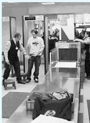
**FIGURA 2** Inspección en los aeropuertos Cuando los pasajeros caminan por debajo del arco, se someten a una serie de pulsos de campo magnético. Si llevan consigo algún objeto metálico, las corrientes inducidas en ese objeto crean su propio “eco” de campo magnético que, al ser detectado, da aviso a los inspectores de que es necesaria una revisión más minuciosa del pasajero.
