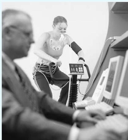
**FIGURA 1** Medición de la energía consumida y el trabajo realizado Un dispositivo que registra la respiración y un dinamómetro permiten conocer tanto la potencia como la tasa metabólica de esta ciclista.
