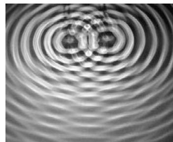
▲ **FIGURA 24.1** Interferencia de ondas en agua La interferencia constructiva y destructiva de las ondas procedentes de dos fuentes coherentes en el agua de un estanque produce figuras de interferencia.
