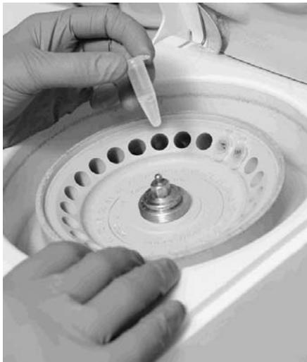
**▲ FIGURA 7.10 Centrífuga** Se usan centrifugas para separar partículas de diferente tamaño y densidad suspendidas en líquidos. Por ejemplo, en un tubo de centrifuga es posible separar los glóbulos rojos de los blancos y del plasma que constituye la porción líquida de la sangre.
