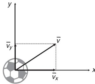
Figura 2.9. Componentes rectangulares de la velocidad  $\vec{v}$
