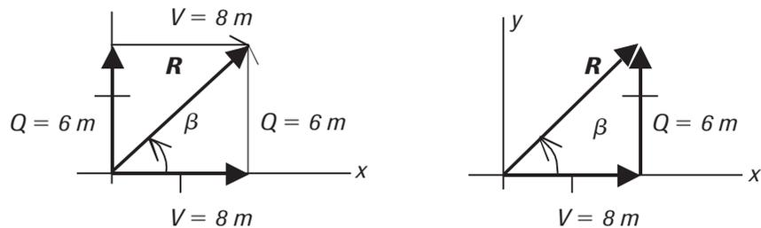
Con base en la escala,  $\mathbf{V}$  tiene una longitud de 4 cm y  $\mathbf{Q}$  de 3 cm, por lo que  $\mathbf{V}$  equivale a 8 m y  $\mathbf{Q}$ , 6 m. Ahora al medir la longitud de  $\mathbf{R}$  se tiene una longitud de 5 cm, equivalente a 10 m. Para medir su dirección utilizamos el transportador, con lo que obtenemos que el ángulo  $\beta$  es de aproximadamente  $37^\circ$ .
