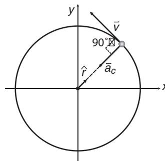
Figura 2.18. Sistema vectorial para el movimiento circular.
