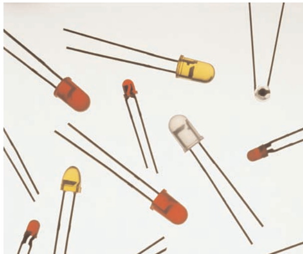
FIGURA 2.8 Aspecto físico del fotodiodo
