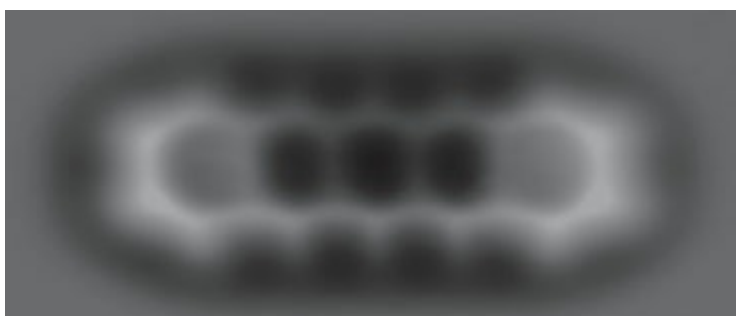
Esta imagen del pentaceno, una molécula conformada por cinco anillos de carbono, fue realizada utilizando un microscopio de poder atómico.
